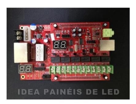
Function Card da marca DBStar para Painéis de LED.
